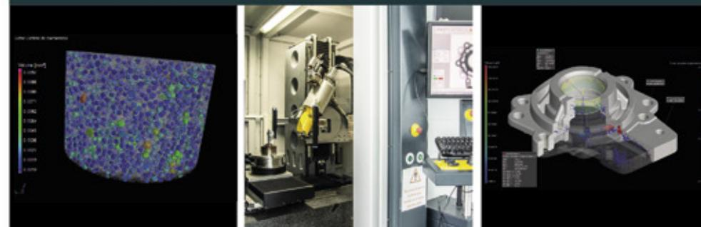
Contrôle non destructif (CND) par rayons X | Contrôle dimensionnel |
